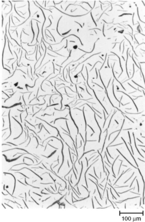
FIGURE V-59 – Microstructure d’une fonte hypereutectique à 4.81% pds  $C_{\text{eq}}$ , plaquettes de graphite type A. Il n’y a pas formation de dendrites proeutectoïdes.
