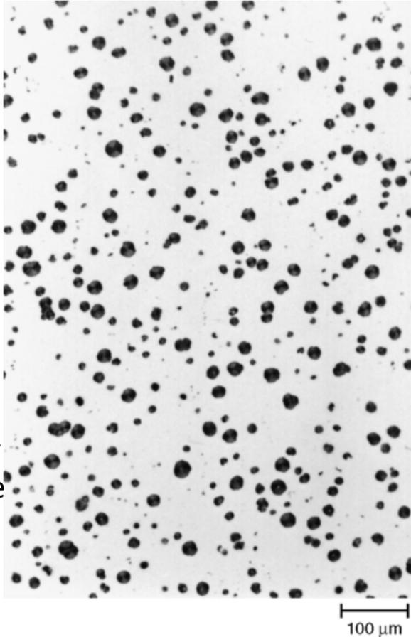
FIGURE V-65 – Graphite sphéroïdal dans une fonte à 4.14% pds  $C_{\text{éq.}}$ .
