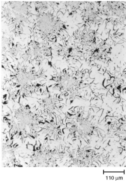
FIGURE V-61 – Microstructure d’une fonte hypereutectique, avec des plaquettes de type B.
